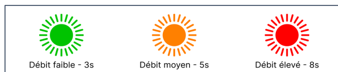
Figure 3 – Indication lumineuse de la consommation instantanée.
