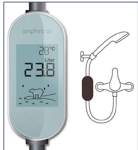
Figure 5 - Amphiro a1, afficheur connecté montrant en temps réel la température, la consommation d'eau et une visualisation symbolique (ours polaire) liée à l'impact environnemental (Tiefenbeck et al. 2016).
